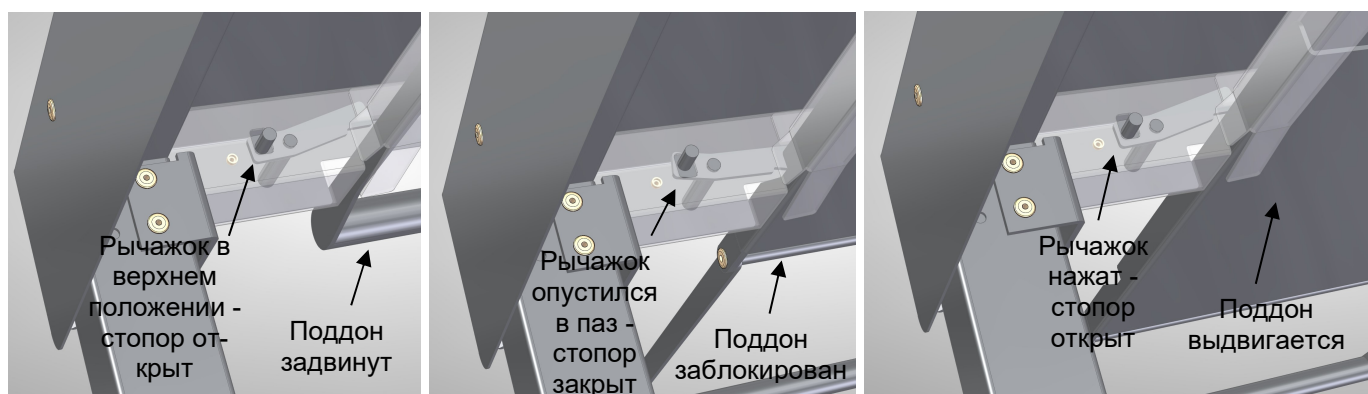
Рис. 3 Последовательность извлечения поддона
