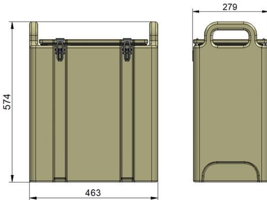
Рисунок 2 – Габаритные размеры термоса универсального переносного
